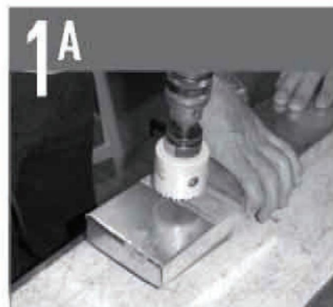
Perforar los dos extremos de las piezas laterales de 1 metro, haciendo un orificio de 7,5 cm (2,5 pulgadas) para permitir las salidas del colector.
