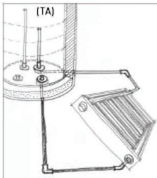
Conectar con mangueras el calentador al tanque de acumulación.
