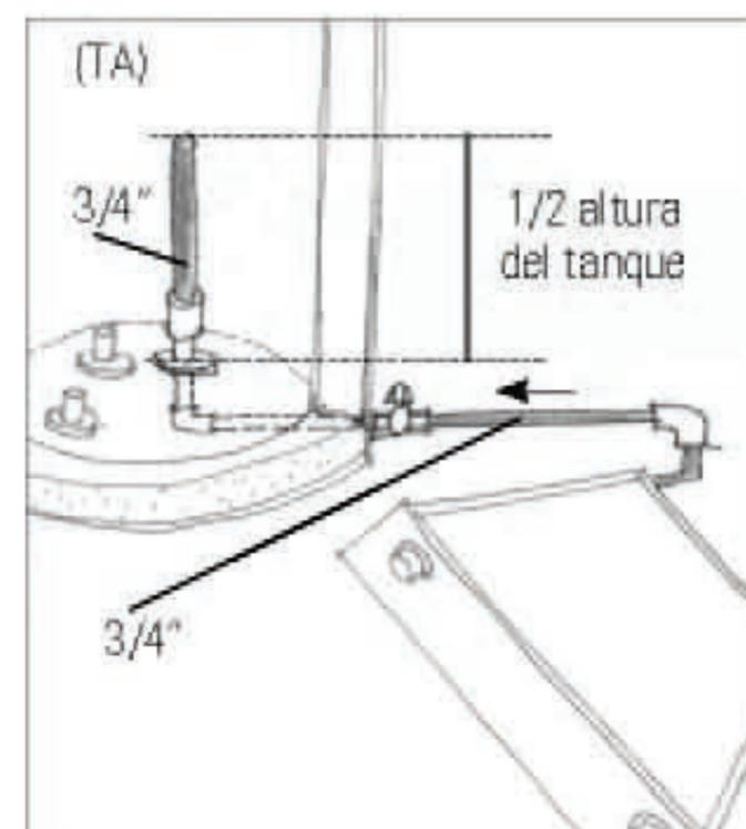
Conectar la manguera desde la salida superior de 3/4" del calentador (agua caliente) a la salida del (TA) con prolongación de caño de la mitad de la altura del tanque (1/2 de de altura del tanque).
