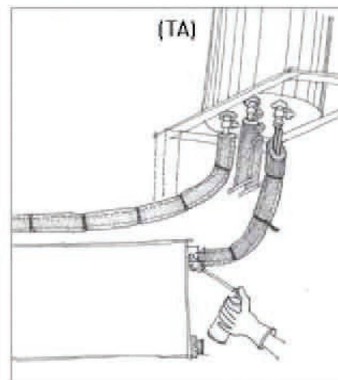
Antes de hacer la conexión, aislar todas las mangueras con aislación para caños sujetándolas con los precintos plásticos.
