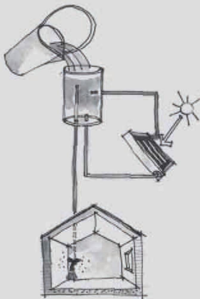
Sistema apoyado en el suelo, sin tanque de reserva (TR) y sin tanque de acumulación (TA).
