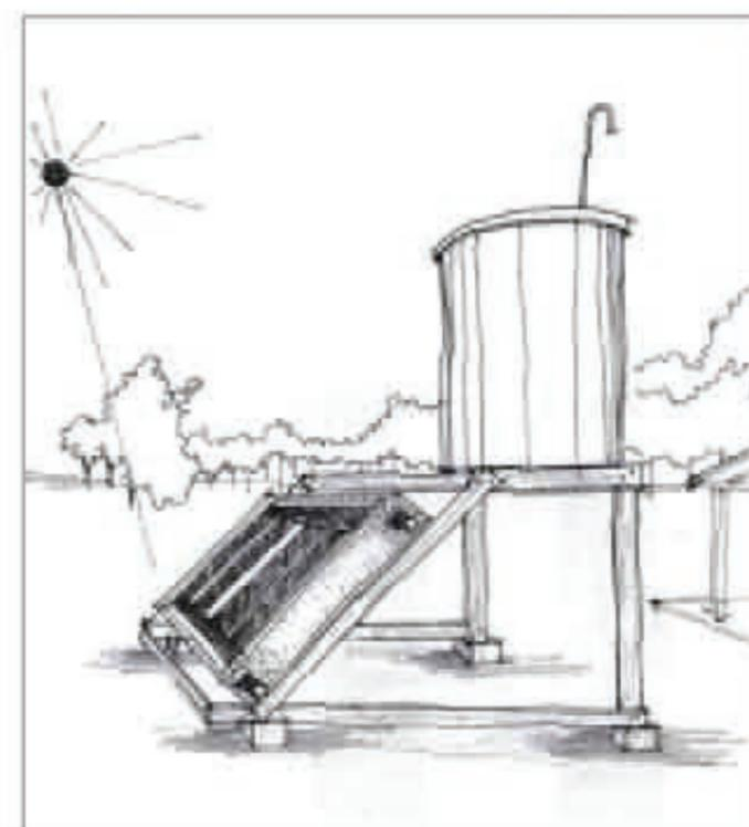
En una estructura, colocar el colector inclinado, a un ángulo de  $60^\circ$  para la región de La Plata, orientado al Norte, evitando que reciba sombras y vientos.
