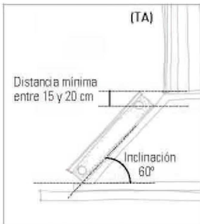
Ubicar el tanque de acumulación a una distancia de 15 a 20 cm entre el fondo del tanque (TA), y la parte superior del calentador.
