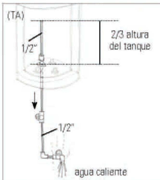
Conectar la manguera desde la salida de 1/2" del (TA) a la vivienda (prolongación 2/3 de altura del tanque).
